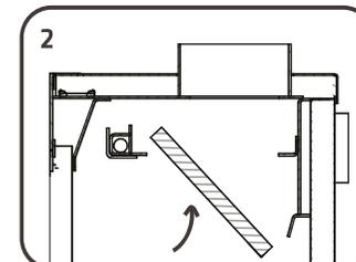
Colocar como indica la fig.2 los ladrillos refractarios sobre los soportes delanteros y luego deslizar hacia atrás hasta hacer tope con el soporte trasero.
