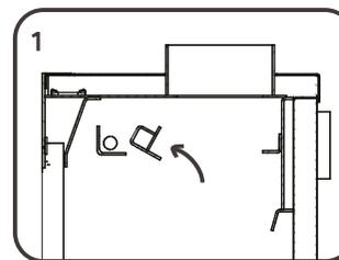
Colocar como indica la fig.1 el tubo aireador sobre los soportes delanteros que se encuentran en las caras laterales de la caja de fuego.
