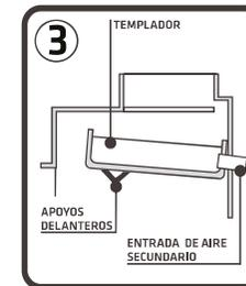
\_Ingresar el templador dentro de la caja de fuego de forma que la cara con orificios quede hacia abajo. Levantarlo como se ve en la imagen sobre los apoyos laterales.
