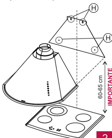
**Paso 2:** Coloque un caño galvanizado o caño corrugado (no incluido) de Ø 6" o Ø 4" desde la salida del motor hasta el caño pasa losa.
