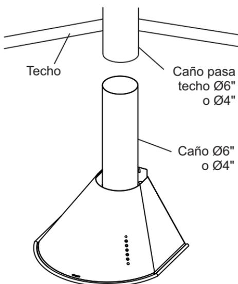
**Paso 3:** Coloque el sombrerete (no incluido) de Ø 6" o Ø 4" fijándolo mediante tornillos Parker o remaches pop.
