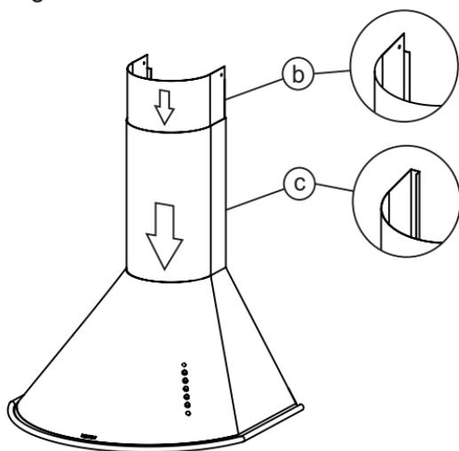
**Paso 5:** Presente el cubre conducto inferior (c) sobre el techo de la Campana. El mismo debe colocarse como indica en la figura de arriba, con las pestañas inferiores por fuera de la campana en la parte de la espalda. Luego encastre el cubre conducto superior (b) dentro del inferior.
