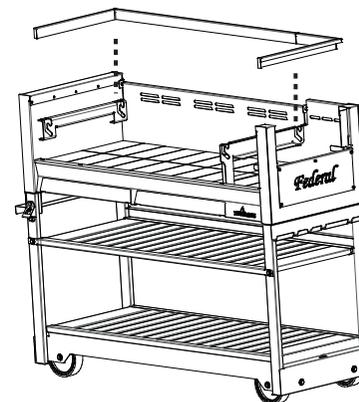
Fig 1 : Coloque los laterales sobre la base y fije los tornillos , con sus arandelas correspondientes, a las tuercas remachadas ubicadas en los extremos de la base.
