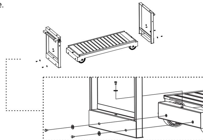
Fig 2 : Antes de montar los laterales de estante, pliegue manualmente hacia adentro la pestaña de tope.
