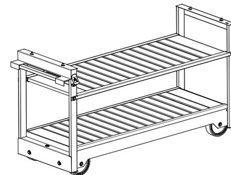
Fig 6 : Coloque el cuerpo de la parrilla sobre la base previamente armada y fije los bulones , con sus arandelas correspondientes, a las tuercas remachadas ubicadas en el inferior de la misma.
